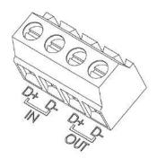
Formez un réseau en chaîne bouclée en connectant les câbles de OUT à IN et toujours de positif à positif et de négatif à négatif entre chacun des connecteurs muraux (voir Exemple de câblage de communication à la page 31).
