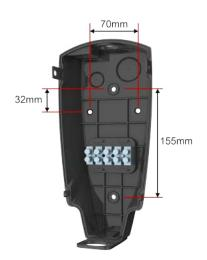
3. Fixez le support à l'aide de fixations adaptées au type de matériau du mur, et réalisez des pré-perçages si cela est nécessaire. Utilisez les vis fournies uniquement en cas de montage direct du support sur un montant en bois. En cas d'installation sur un autre type de mur (creux, maçonnerie, etc.), utilisez des fixations suffisamment longues pour accrocher solidement le connecteur mural, et capables de supporter un poids minimum de 36 kg.
